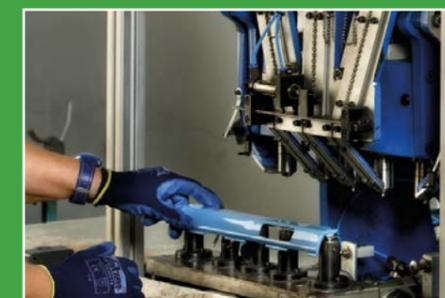
El exclusivo mecanismo de anillas es la parte más compleja del archivador. Está compuesto por más de 15 piezas y en su elaboración son necesarias multitud de matrices, tornos y maquinaria especialmente diseñada para su fabricación. El proceso productivo finaliza con un ensamblaje manual que garantiza el perfecto funcionamiento del sistema de archivo.
